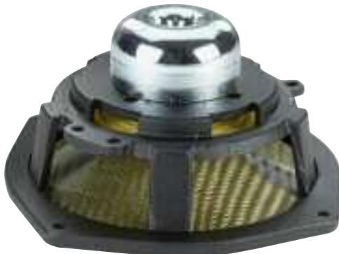
Der völlig neu entwickelte Mitteltöner hat eine sehr leichte, gewebte Kevlar-Membranfläche von 100 Quadratzentimetern
