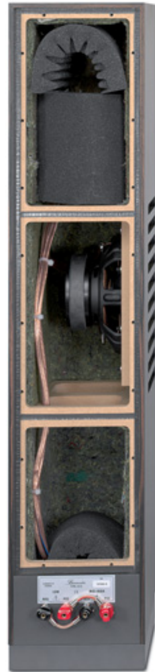
Gut sichtbar: Die Basskammer ist sparsamer und nur mit Filz bedämpft
