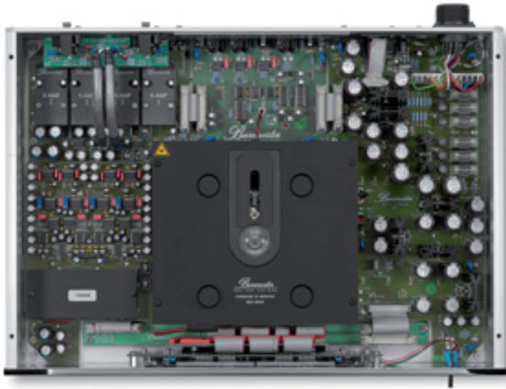
Links des Laufwerks befindet sich die Signalplatine mit den X-AMPs und der geschirmten Upsampling-Elektronik. Rechts werden die Spannungen aufbereitet
